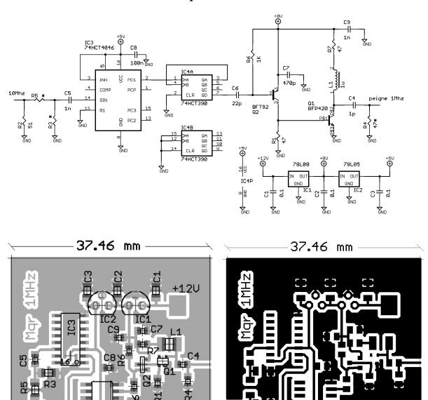
Ce montage, destiné à être monté dans un boîtier Shubert 37x37mm, génère des harmoniques jusqu'à au moins 10GHz à partir d'un signal 10MHz.
